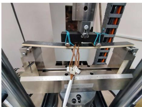
Рис. 11. Испытания на четырёхточечный изгиб тест-образца со структурой несущих слоёв [0°]
