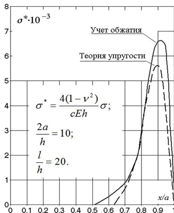
Рис. 3. Сравнение контактных напряжений, полученных по теории упругости и теории пластин с учетом обжатия
